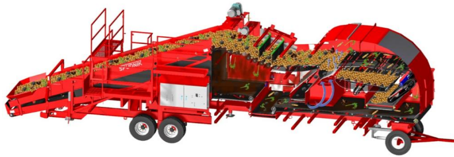
图 1-3 格立莫 AirSep991 型马铃薯空气动力清选机
